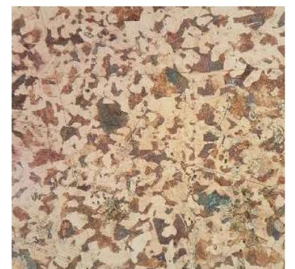
Acier au carbone ferrito-perlitique avec un peu plus de ferrite que de perlite (0,38%C) - Dureté 150HV
