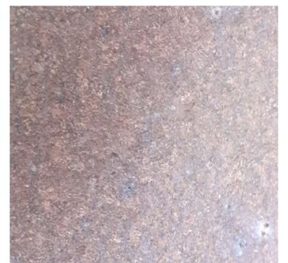
Acier au carbone austénisé ( $\approx 900^{\circ}C$ ), trempé à l'eau ( $\approx 20^{\circ}C$ ) puis ayant subi un recuit de revenu ( $\approx 500^{\circ}C$ ) - dureté  $\approx 700HV$
