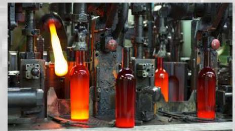
Procédé de soufflage automatique pour l'élaboration de bouteilles (saverglass)
