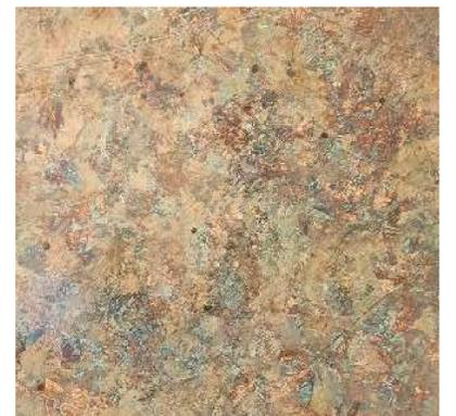
Acier au carbone perlitique ne contenant que de la perlite (0,80%C) - Dureté 200HV
